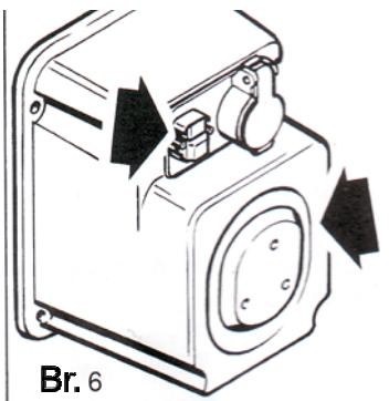
Na slici su označene tipke sa kojima se mešalica uključuje i isključuje. Usled kratkog spoja ili pada električnog napona, prekidač se ne da uključi. Po uspostavljanju napona uključenje prekidača je moguće.
